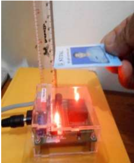
Gambar 01 Pengujian jarak baca RFID reader.
