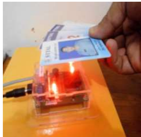
Gambar 03 Pengujian kemampuan baca RFID reader.
