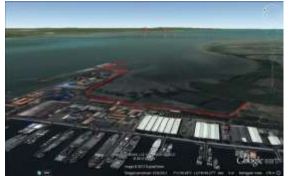
Gambar 1. Garis merah merupakan jalur pipa yang direncanakan.
