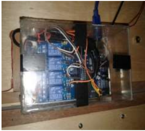
Gambar 23 Rangkaian arduino , solenoid dan relay .
